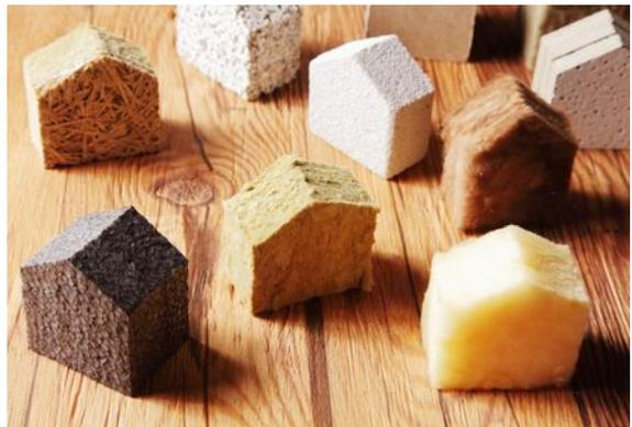
*Des échantillons d'isolants de conductivités thermiques comprises entre 0,020 et 0,050  $W.m^{-1}.K^{-1}$*
